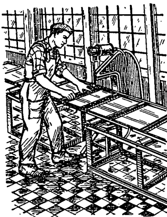
Рис. 119. Клепка перегородки на клепальном прессе
