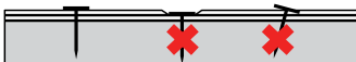
Рисунок 15 – Крепление битумной черепицы
